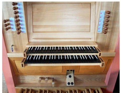
Der neue Arbeitsplatz an der Orgel: Zwei Manuale, Pedal und die Registerzüge für die drei Orgelwerke
